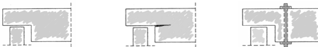
Fig. 1. Fenda en el rebaje de la viga entallada y aplicación de refuerzo mediante perno.
